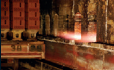
Seitenbefeuerung des Ofens Side-fired kiln
