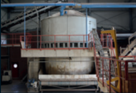
Großer Kollergang mit vier Läufern Large wet pan with four runners
