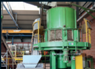
Siebrundbeschicker für die neuen Pressenlinien Circular screen feeder for new pressing lines
