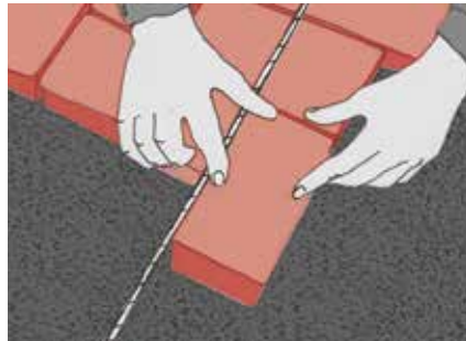
21. Mit der Richtschnur kann die Ausrichtung des Verbandes kontrolliert werden. Für eine Flachverlegung wird eine Mindestfuge von 3 bis 4 mm gefordert. Entscheidende Gründe dafür sind zum einen der notwendige Ausgleich der unvermeidbaren Herstellungstoleranzen und zum anderen die Stabilität der Fläche, die nur durch vollflächige ausgefüllte Fugen erbracht werden kann. Durch Belastungen des Belages treten Schubkräfte auf, die durch die Fuge ausgeglichen werden. Die Fuge verhindert dabei, dass das Pflastermaterial aneinander kantet und Abplatzungen entstehen.
