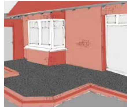
19. Nach Verfestigung und Abziehen der Bettung kann nun mit der eigentlichen Pflasterverlegung begonnen werden.
