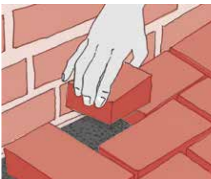
23. In der Abbildung ist ein Fischgrätverband rechtwinklig zur Fassade zu sehen. Die hierdurch anfallenden Ergänzungssteine in Form von halben Steinen werden im Vorfeld geschnitten und sofort mit verlegt.
